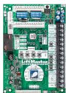
Inclus la carte Logic 4.0 et le Maintenance Alert System™ (système d'alerte de maintenance) exclusif.
