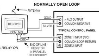
IF REQUIRED, CONNECT AN END-OF-LINE RESISTOR AT THE RECEIVER AS SHOWN
