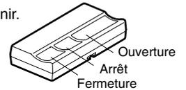
Lorsque l'éclairage de l'ouvre-porte clignote, relâcher tous les boutons. Faire un essai en appuyant sur le gros bouton (Ouverture) de la télécommande. La porte devrait s'ouvrir. Appuyer à nouveau tandis que la porte est ouverte et rien ne devrait se produire. Appuyer sur le bouton moyen (Fermeture) tandis que la porte bouge, et la porte devrait se fermer. Appuyer sur le troisième bouton (Arrêt), et elle devrait s'arrêter immédiatement.
