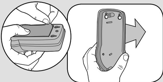
Décoller le papier du ruban de montage. Appuyer fermement l'interphone sur la surface de montage.
