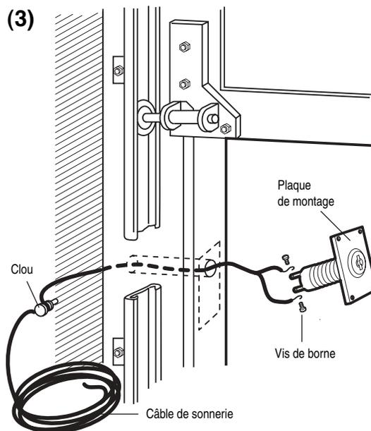
**4ème ETAPE :** Si les clous ne fixent pas assez fermement la plaque, utiliser l'ancre et l'écrou fournis avec les pièces (Voir l'illustration à page 2). Si l'ancre et l'écrou sont utilisés, ôter les bornes du clé extérieur de verrouillage.
