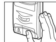
3. Maintenir les deux boutons enfoncés tout en appuyant sur le bouton-poussoir de la console de commande de détection de mouvement (les trois boutons sont enfoncés).
