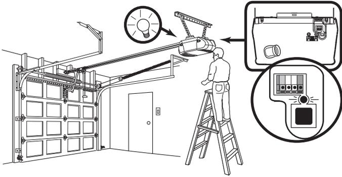
**REMARQUE :** L'appareil doit avoir un utilisateur inscrit avant d'être programmé au dispositif d'ouverture. Étant donné l'intervalle de 30 secondes, une deuxième personne peut être nécessaire pour appuyer sur le bouton « learn » (« apprendre »). Si personne n'est présent pour appuyer sur le bouton « learn » (« apprendre ») violet, reportez-vous à la section Dépannage.
