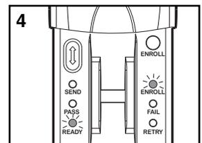
5. Un nouvel utilisateur doit faire glisser lentement et fermement son doigt de haut en bas du capteur de bande jusqu'à ce que trois passages réussis soient réalisés.
