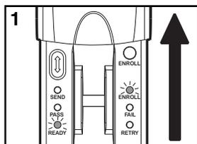
2. Faites glisser votre doigt lentement et fermement sur le capteur de bande jusqu'à ce que trois passages réussis soient réalisés.
