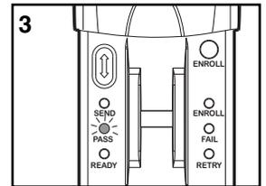
**REMARQUE :** Si le couvercle est déjà ouvert, appuyez sur le bouton Resend (Renvoyer) ou sur le bouton Enroll (Inscrire) pour allumer l'appareil. La LED Fail (Échec) ou Retry (Réessayer) s'allume si un autre passage est nécessaire. Auquel cas, faites glisser lentement et fermement avec plus de pression. Plusieurs passages sont parfois nécessaires pour réussir un passage.
