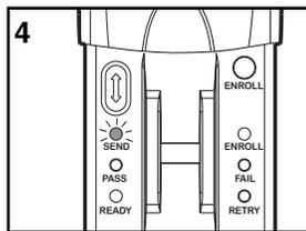
5. Si les lumières du dispositif d'ouverture ne clignotent pas, appuyez puis relâchez le bouton Resend (Renvoyer) à 1 seconde d'intervalle pendant 5 secondes jusqu'à ce que les lumières du dispositif d'ouverture clignotent ou que la porte bouge. La programmation est terminée.
