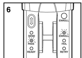
**REMARQUE :** Si le couvercle est déjà ouvert, appuyez sur le bouton Resend (Renvoyer) ou sur le bouton Enroll (Inscrire) pour allumer l'appareil. La LED Pass (Réussi) s'allume lorsqu'un passage réussi est réalisé. La LED Retry (Réessayer) s'allume si un autre passage est nécessaire.
