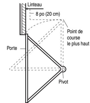
Porte rigide sans guides : basculant sur pivots
