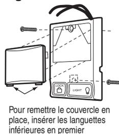
Pour remettre le couvercle en place, insérer les languettes inférieures en premier
