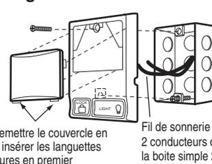
Pour remettre le couvercle en place, insérer les languettes inférieures en premier
